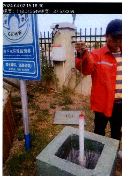
图 3 综合主厂房 2#地下水采样照片
