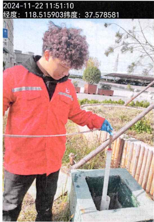
图 3 综合主厂房 2#地下水采样照片
