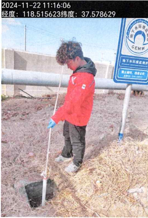
图 2 厂区西北侧 1#地下水采样照片
